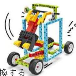
体操選手は鉄棒でダイナミックに回転します。そのエネルギーを運動エネルギーに変換する車を作ります。ラチェットの掛け方によって車の動きがどのように変わるか観察しましょう。振り子の実験を通して車をより遠くまで進ませる方法を調査していきます。
